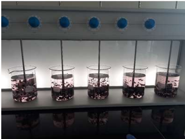
실험실 최적응집교반실험(Jar Test)
